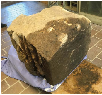
9. Bodenfeuchter Sandstein hat eine sehr verletzte Oberfläche. Darum muss das Stück erstmal einige Wochen trocknen, bevor es vorsichtig gereinigt werden kann.
