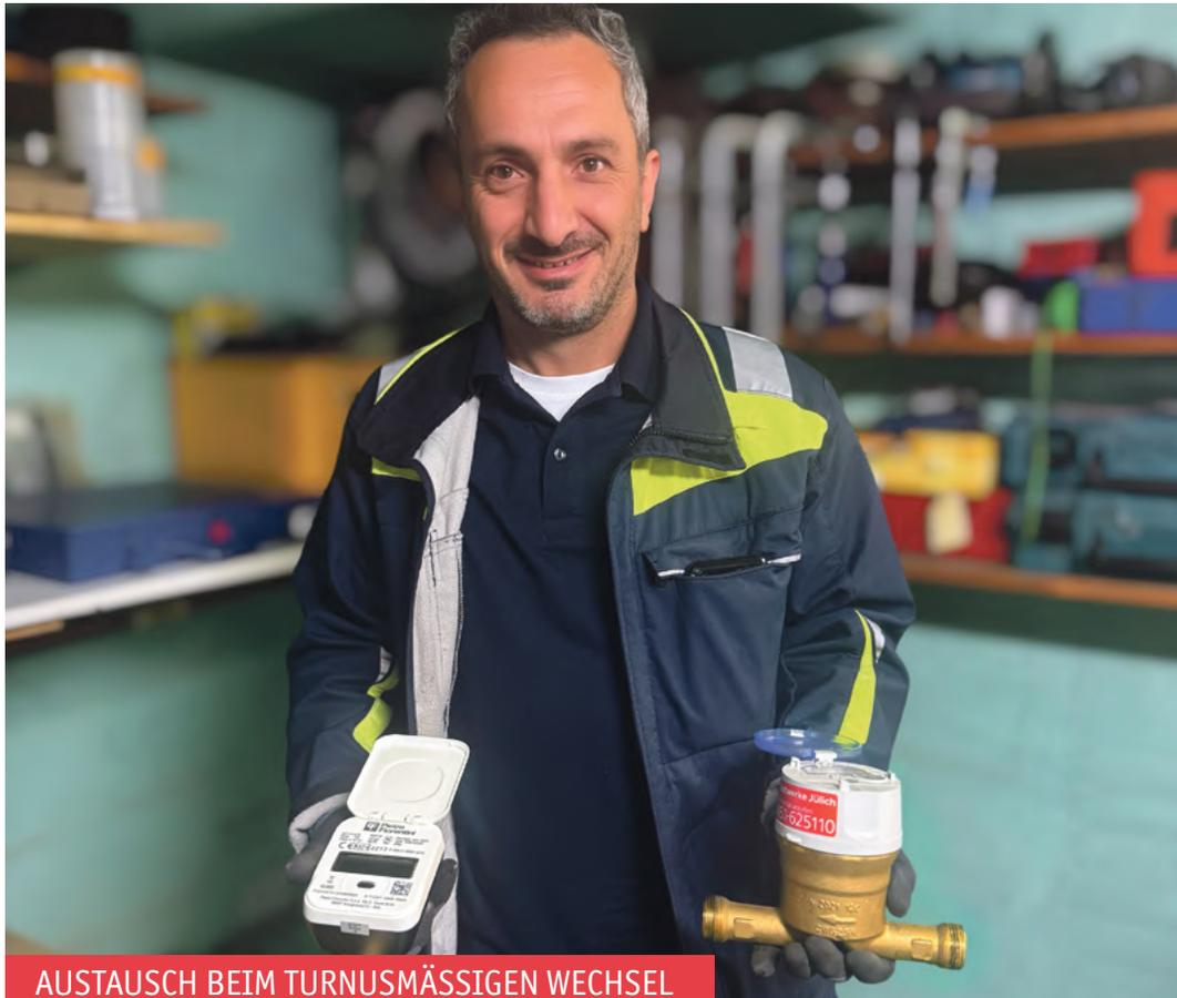
Cengin Aktas, Zähler-Monteur bei den Stadtwerken, zeigt, wie die neuen Ultraschall-Wasserzähler (links) gegenüber den bisher eingesetzten Zählern (rechts) aussehen.
